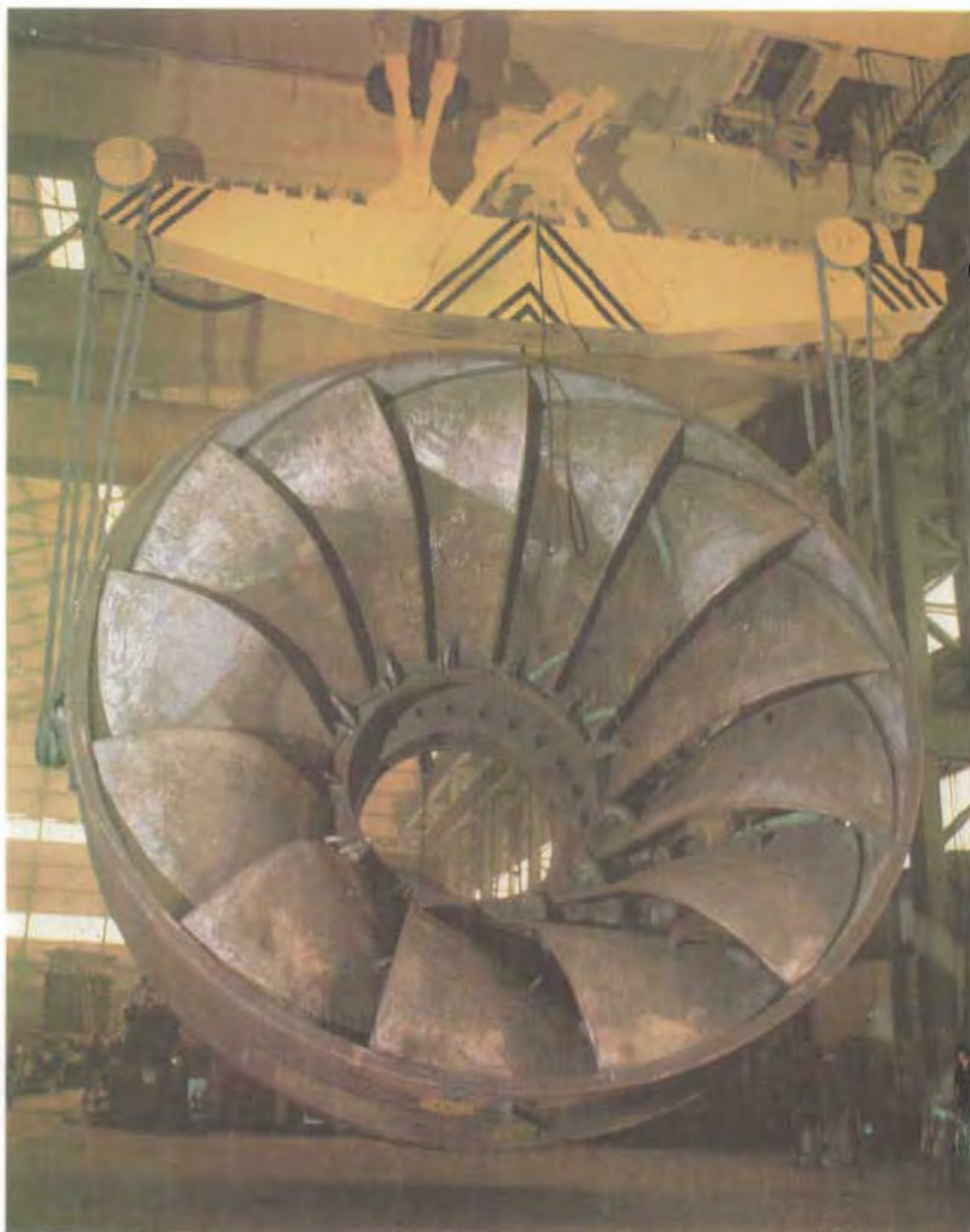
Una vista del montaje final de la rueda de la turbina N° 1, en las instalaciones industriales de la Voith (Estado de São Paulo, Brasil), compuesta de corona, cinta y trece palas, con un peso total de 300 ton. Esta pieza compacta será transportada al Sitio de Obras en Diciembre de 1981.
