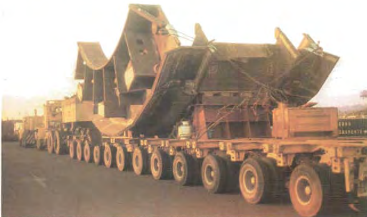
Transporte del predistribuidor, desmontado en cuadrantes, hacia el sitio de obras, al final del primer semestre de 1980.
